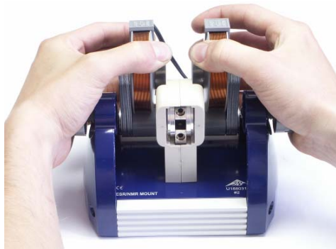
Fig. 4 Divaricazione dei due magneti permanenti
