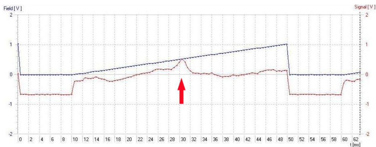
Fig. 14 Representação da tela no 3BNET/lab™ (Poliestireno \nu \approx 12,854 MHz)
