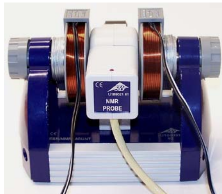
Fig. 8 Unidade base com cabeça de medição
