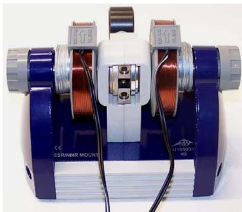
Fig. 6 Unité de base équipée de l'aimant permanent et des bobines
