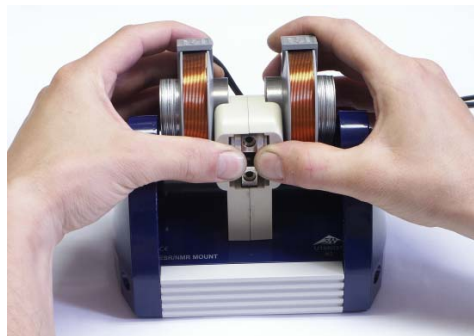
Fig. 5 Portare il magnete sui dischi di montaggio
