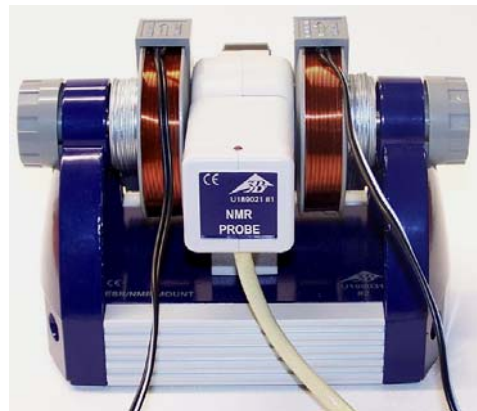
Fig. 8 Unità di base con testina di misura
