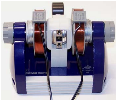
Fig. 6 Basiseinheit mit Permanentmagnet und Spulen komplettiert
