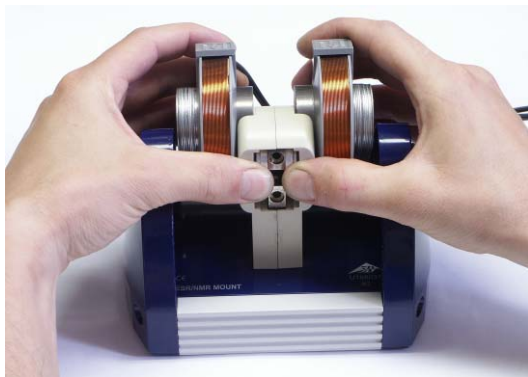
Fig. 5 Imanes se deslizan sobre los discos de montaje
