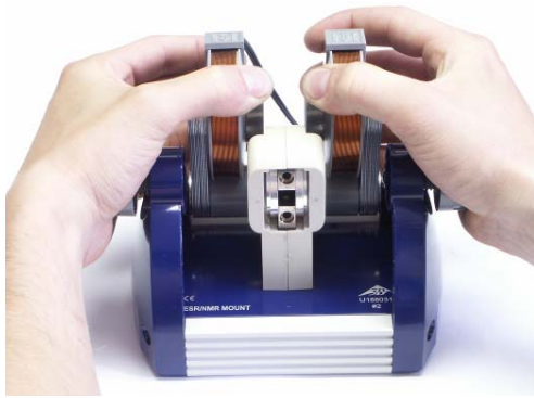
Fig. 4 4 Separación de los dos imanes permanentes
