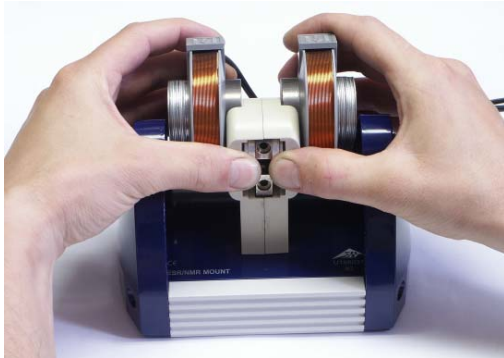
Fig. 5 Magneten auf die Montagescheiben ziehen
