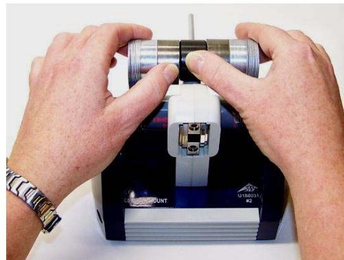
Fig. 3 Lösen des Jochs vom Permanentmagneten
