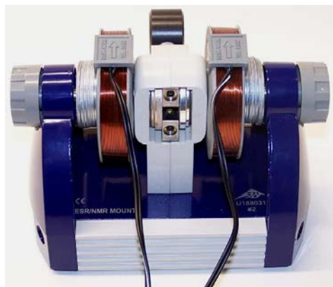
Fig. 6 Unità di base completa di magneti permanente e bobine
