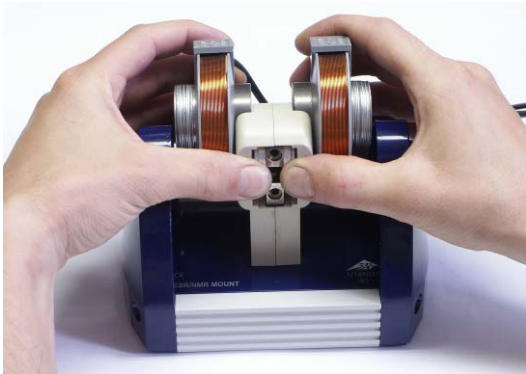
Fig. 5 Tirer les aimants sur les bagues de montage
