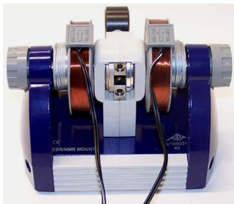
Fig. 6 Unidad básica completada con el imán permanente y las bobinas
