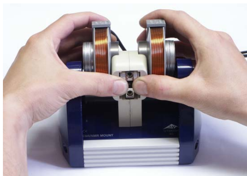
Fig. 5 Puxar os ímãs sobre os discos de montagem
