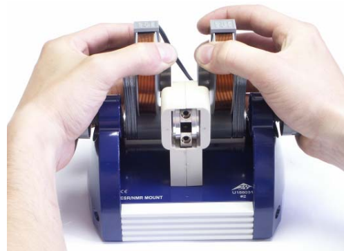
Fig. 4 Spreizen der beiden Permanentmagneten
