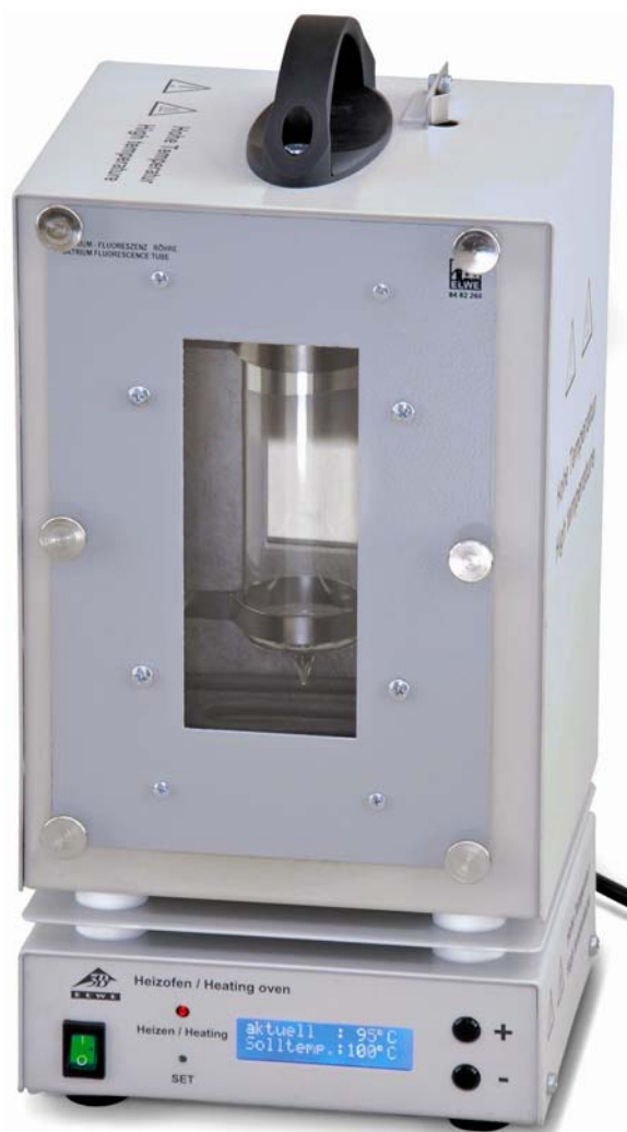
Fig. 1 Parede de forno montada no forno com tubo de fluorescência de sódio
