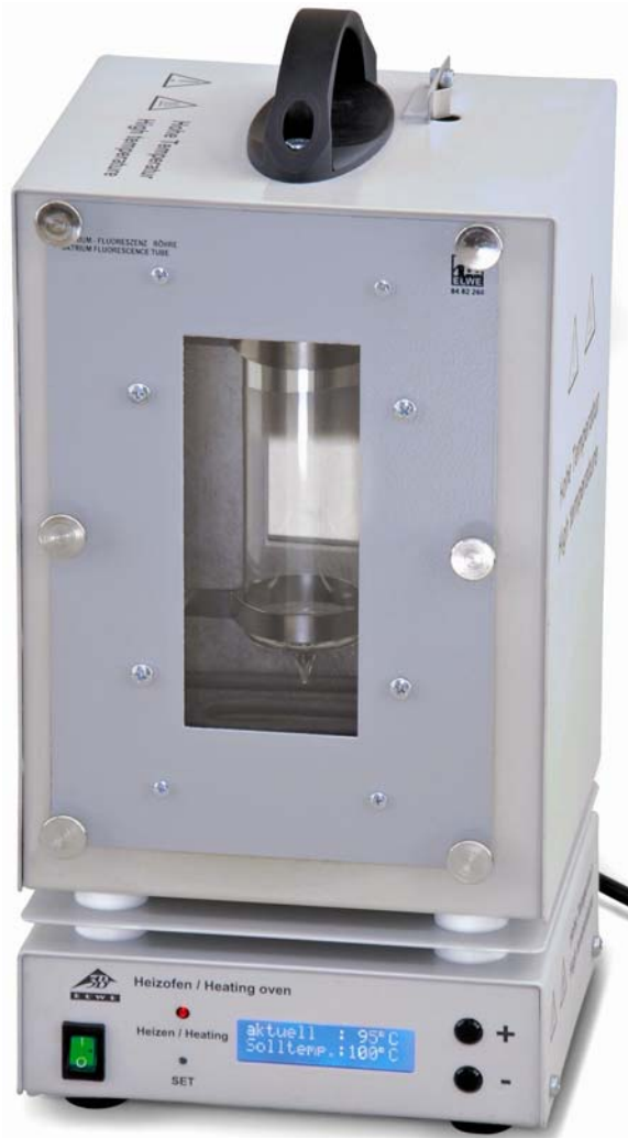
Fig. 1 Am Heizofen montierte Ofenwand mit Na-Fluoreszenz-Röhre
