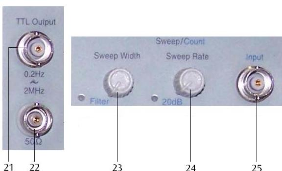
21 Presa di uscita per segnale TTL, impedenza 600 Ω
