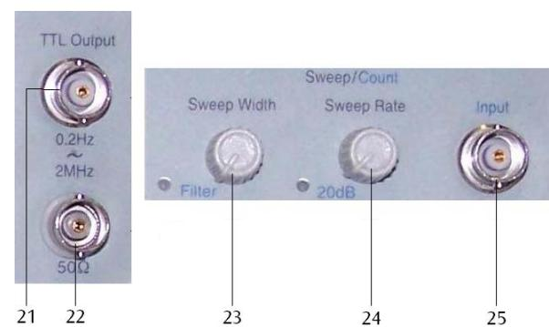
21 Casquillo de salida para la señal TTL, Impedancia 600 Ω
