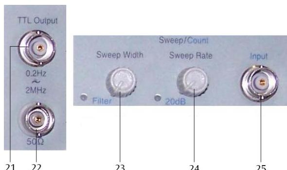
21 Conector de saída para sinal TTL, impedância 600 Ω
