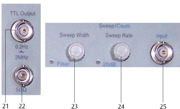
21 Prise de sortie pour signal TTL, impédance 600 Ω
