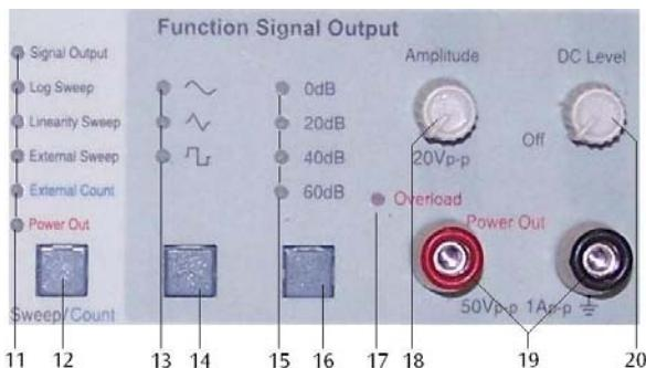
11 Indicación de la forma de funcionamiento (LEDs)
