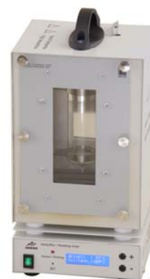
Fig. 2 Forno de aquecimento com o tubo de fluorescência de sódio (1000913)
