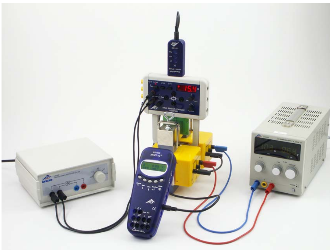
Fig. 1 Medição da densidade de fluxo no entreferro entre as sapatas polares de um eletro-ímã na montagem de experiência no aparelho base para o efeito de Hall
