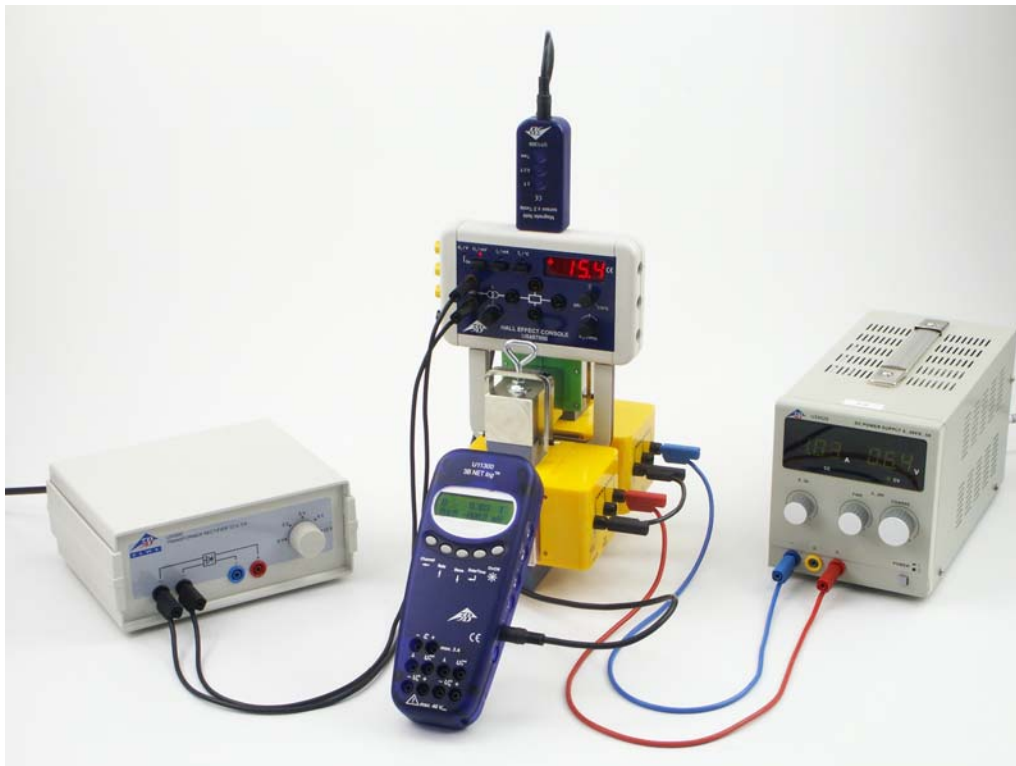
Fig. 1 Medición de la densidad de flujo magnético en la ranura de aire entre las piezas polares de un electroimán en el montaje experimental para el aparato básico del efecto Hall
