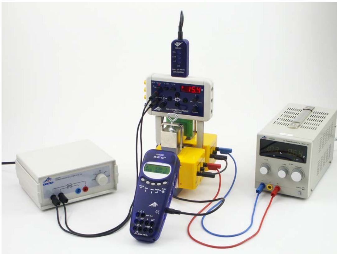
Fig. 1 Misurazione della densità di flusso nel traferro fra le espansioni polari di un elettromagnete nella struttura sperimentale relativa all'apparecchio di base per effetto Hall
