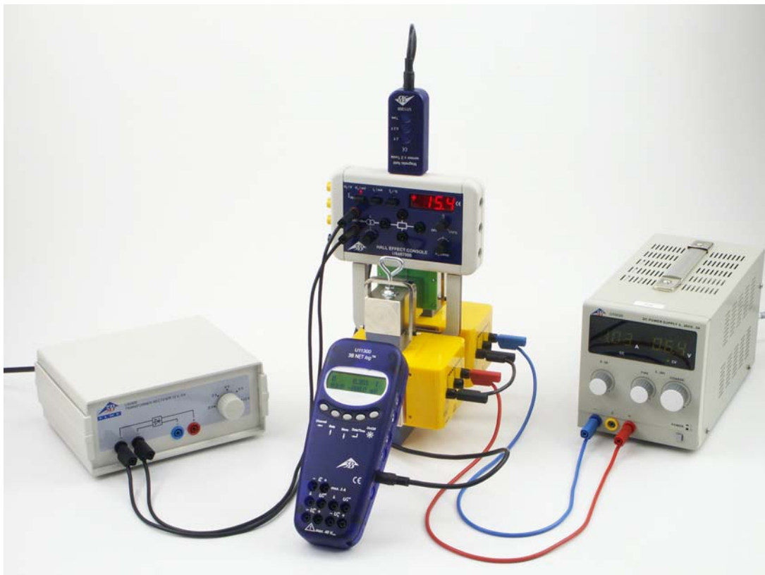
Fig. 1 Mesure de la densité du flux dans la couche d'air entre les cosses d'un électro-aimant dans le montage expérimental de l'appareil de base à effet Hall
