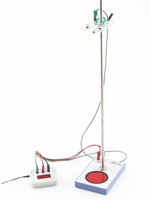
Fig 2 Contador de milisegundos y aparato de caída libre
