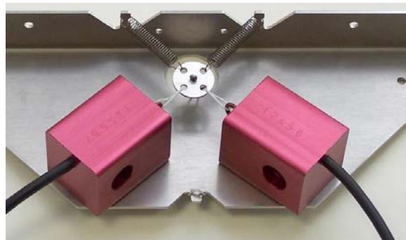
Fig. 2 Fijación de los sensores de fuerza en el grupo constructivo del muelle
