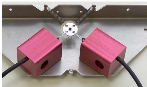
Fig. 2 Fissaggio dei sensori di forza al gruppo molla
