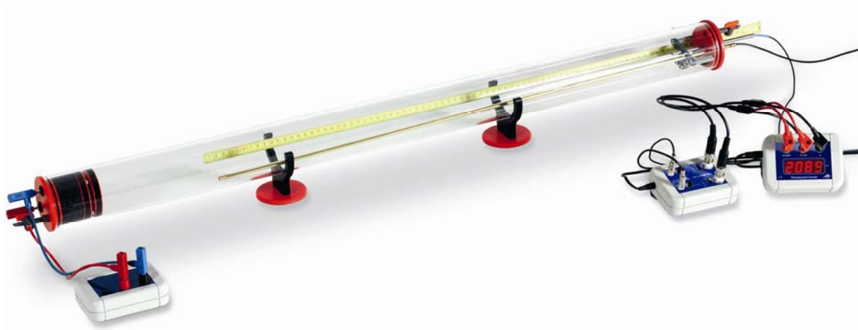
Fig. 2: Struttura sperimentale con il tubo di Kundt
