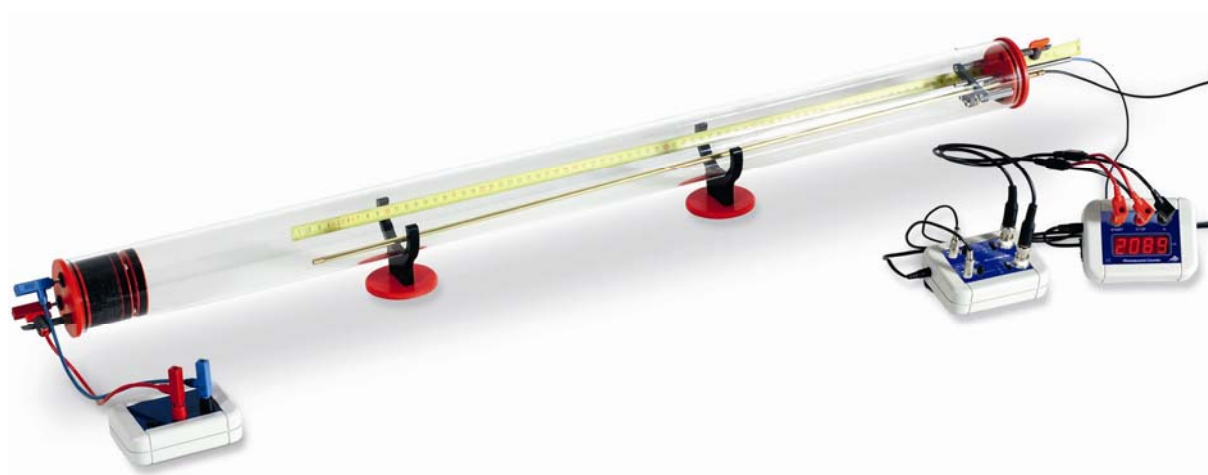
Figura 2. Montagem do experimento com tubo de Kundt
