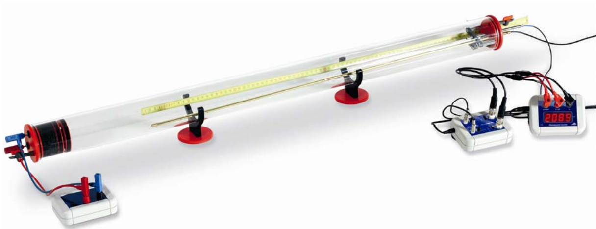
Fig. 2: Montaje experimental con el tubo de Kundt
