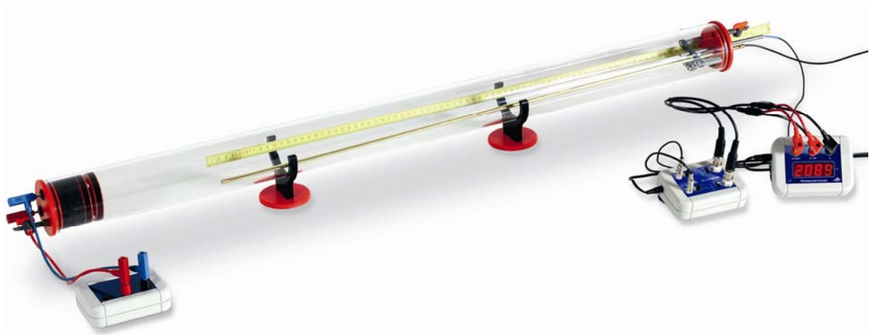
Fig. 2 : Montage expérimental avec le tube de Kundt
