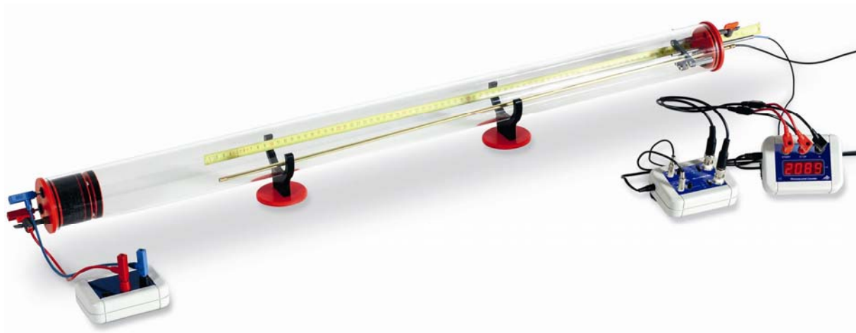
Fig. 2: Montagem do experimento com tubo de Kundt
