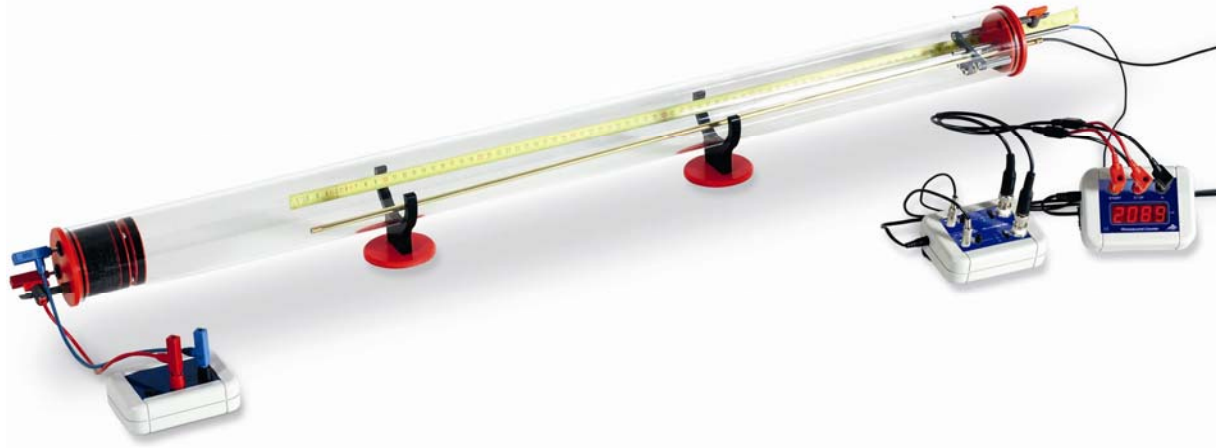
Fig. 2: Experimenteller Aufbau mit dem Kundt'schen Rohr
