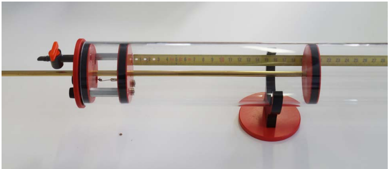
Fig. 1 Sonde microphone avec disque de sonde vissé
