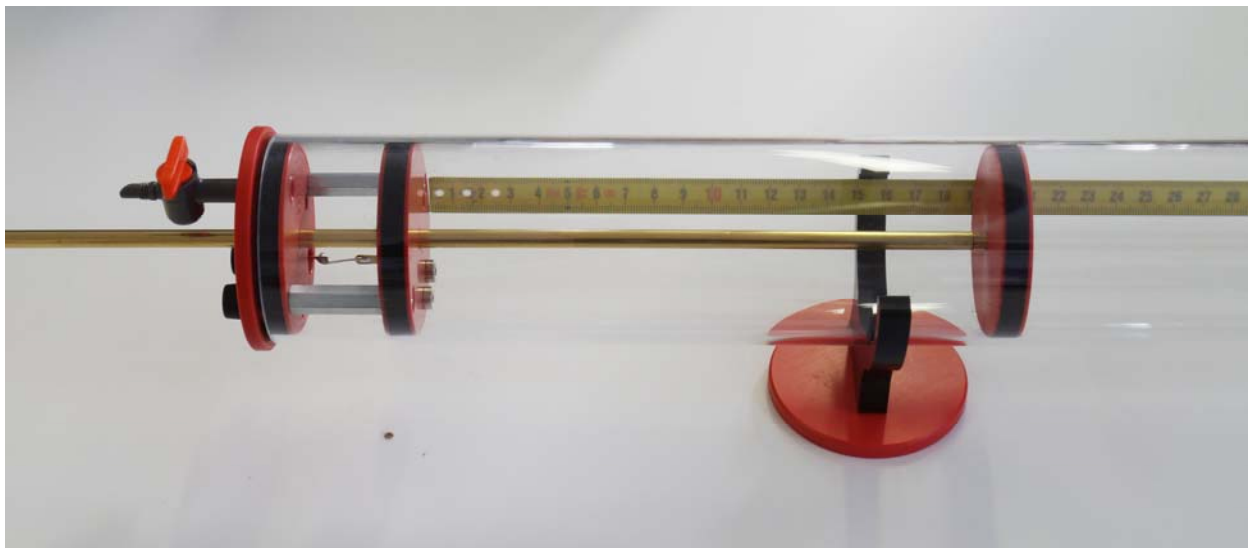
Fig. 1 Mikrofonsonde mit aufgeschraubter Sondenscheibe
