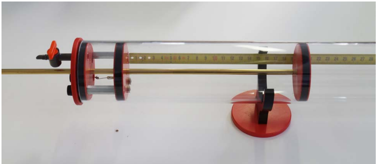
Fig. 1 Sonda microfono con disco sonda avvitato
