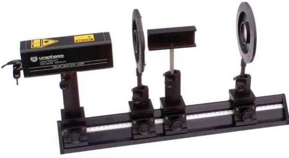
Fig. 4: Struttura dell'esperimento “Esperimento classico sull'interferenza”. Posizione dei componenti (bordo di sinistra del cavaliere ottico): laser: 0 mm, lente f = 5 mm: 150 mm, specchio di Fresnel: 220 mm, lente f = 200 mm (solo montata, se viene misurata la distanza delle sorgenti luminose virtuali): circa 380 mm. L'immagine di interferenza viene ottenuta su uno schermo (o una parete chiara) con una distanza compresa tra 2 e 3 m.
