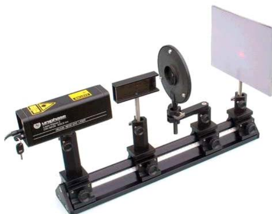
Fig. 3: Struttura dell'esperimento "Esperimento sull'interferenza compatto"
