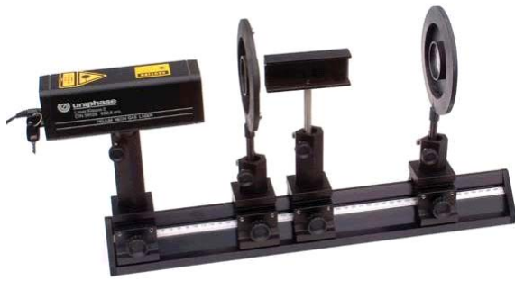
Fig. 4: Montaje experimental "Experimento clásico de interferencia" Posición de los componentes (borde izquierdo de la corredera óptica): Láser: 0 mm, lente f = 5 mm: 150 mm, espejo de Fresnel 220 mm, lente f = 200 mm (sólo montado, si se mide la distancia de las fuentes de luz virtuales): aprox. 380 mm. La imagen de interferencia se mantiene sobre una pantalla (o una pared clara) que se encuentre a una distancia de 2 a 3 m.
