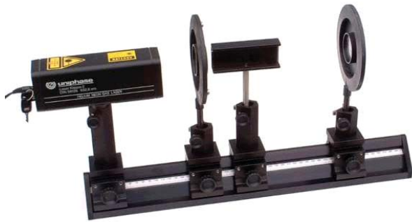
Fig. 4: Versuchsaufbau „klassischer Interferenzversuch“. Position der Komponenten (linke Kante der Optikreiter): Laser: 0 mm, Linse f = 5 mm: 150 mm, Fresnel-Spiegel: 220 mm, Linse f = 200 mm (nur montiert, wenn der Abstand der virtuellen Lichtquellen gemessen wird): ca. 380 mm. Das Interferenzbild wird in 2 bis 3 m Entfernung auf einem Schirm (oder einer hellen Wand) erhalten.
