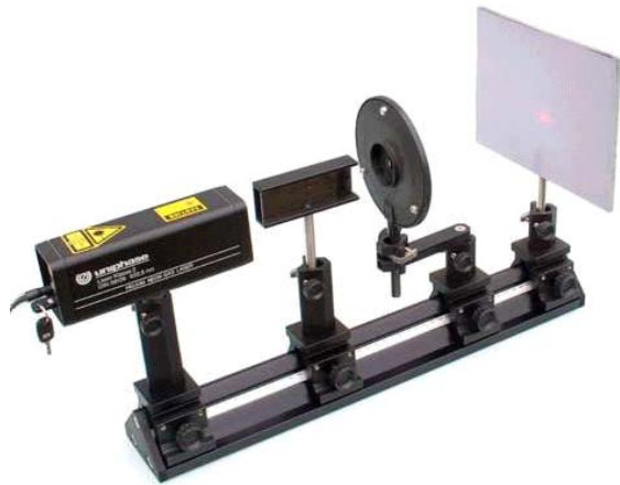
Fig. 3: Montaje experimental “Experimento compacto de interferencia”
