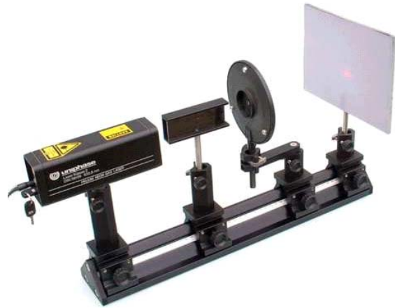
Fig. 3: Versuchsaufbau „Kompakter Interferenzversuch“
