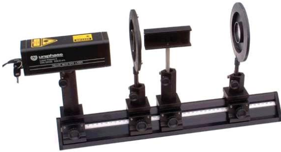
Fig. 4: montagem do ensaio “Experiência clássica de interferência”. Posição dos elementos (aresta esquerda do cavalete óptico): laser: 0 mm; lente f= 5 mm: 150 mm; espelho de Fresnel: 220 mm; lente f= 200 mm (só montado quando a distância da fonte luminosa virtual é medida): aprox. 380 mm. A imagem da interferência será visível de 2 a 3 m de distância sobre uma tela (ou numa parede clara).
