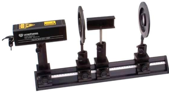
Fig. 4 : Montage « Expérience d'interférence classique ». Position des composants (bord gauche du coulisseau optique) : laser : 0 mm, lentille f = 5 mm : 150 mm, miroir de Fresnel : 220 mm, lentille f = 200 mm (uniquement montée si l'on mesure l'écart entre les sources lumineuses virtuelles) : env. 380 mm. L'image d'interférence est obtenue sur un écran (ou un mur clair) à 2-3 m de distance.
