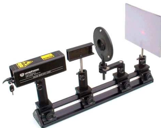
Fig. 3: montagem do ensaio “Experiência compacta de interferência”
