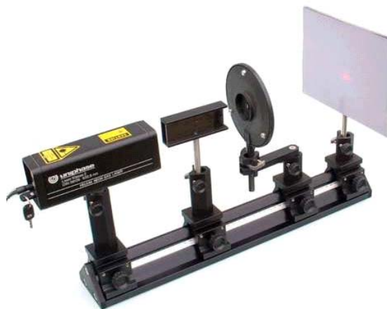
Fig. 3 : Montage « Expérience d'interférence compacte »
