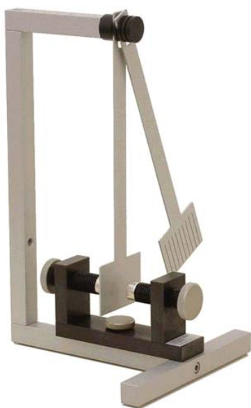
Fig. 5 : Courants de Foucault induits
