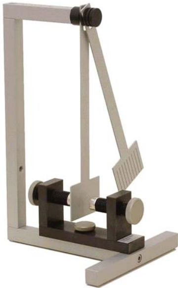
Fig. 5: Versuchsaufbau „Induzierte Wirbelströme“
