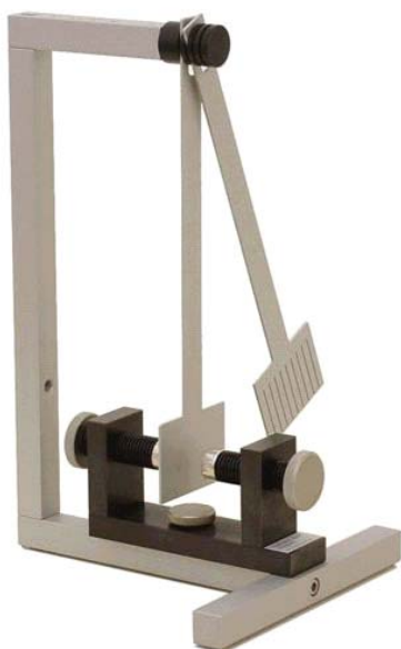
Fig. 5 : Montaje experimental "Corrientes parásitas inducidas"
