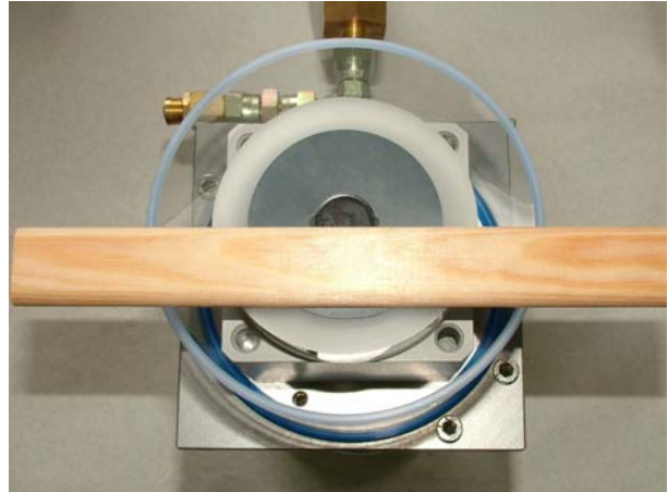
Fig. 9: Allineamento della guarnizione in gomma tonda
