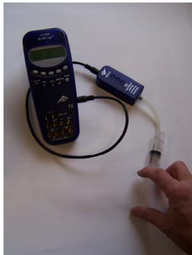
Fig. 1 Medição da pressão absoluta em função do volume
