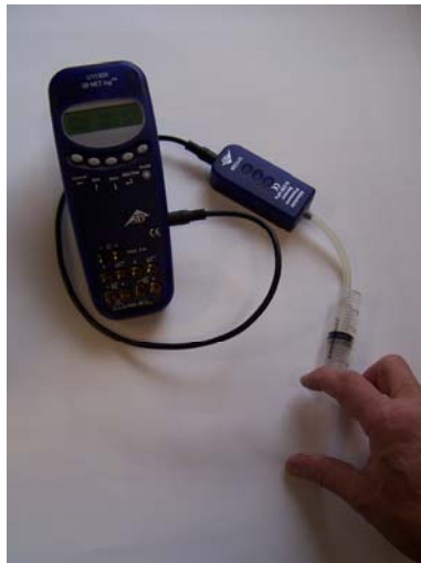
Fig. 1 Misurazione della pressione assoluta in funzione del volume
