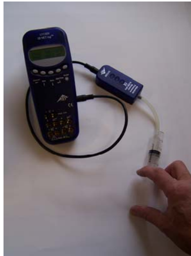
Fig. 1 Messung des absoluten Drucks in Abhängigkeit vom Volumen
