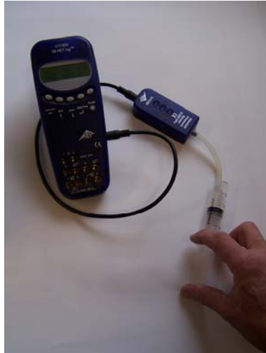
Fig. 1 Medición de la presión absoluta en función del volumen
