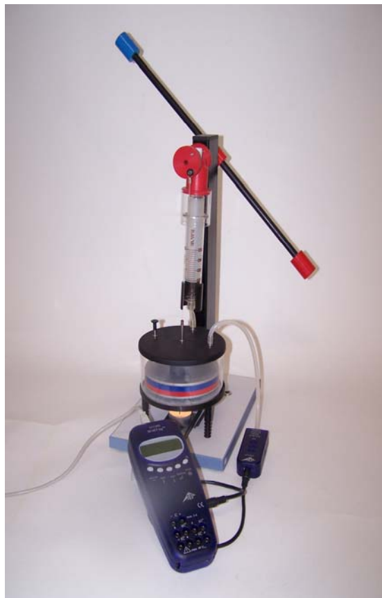
Fig. 1 Struttura dell’esperimento per la registrazione dei valori della pressione di esercizio nel motore Stirling del prof. Wilke rotante
