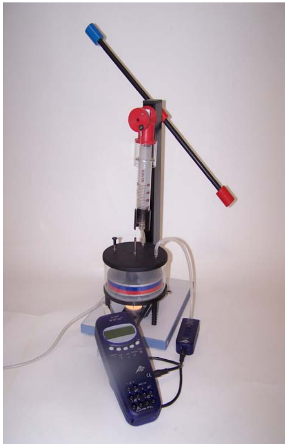
Fig. 1 Montaje de experimentación para el registro de los valores de presión de trabajo de un motor de Stirling según Wilke en rotación
