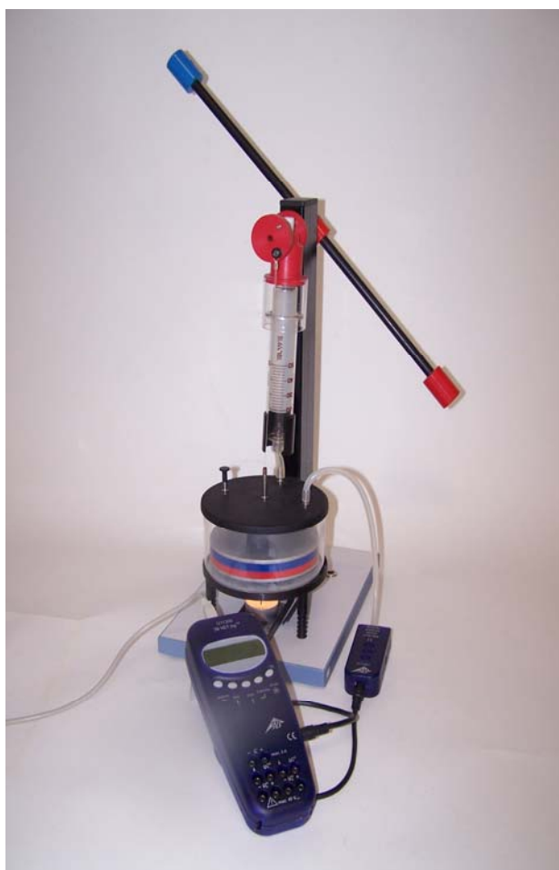
Fig. 1 Montage de l'expérience destiné à l'enregistrement des valeurs de pression de service dans le moteur Stirling d'après Wilke en rotation
