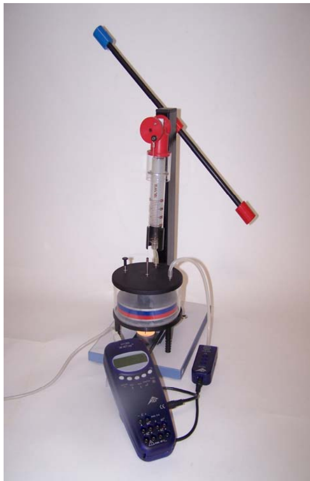
Fig. 1 Versuchsaufbau zur Aufnahme der Betriebsdruckwerte im rotierenden Stirling-Motor nach Wilke
