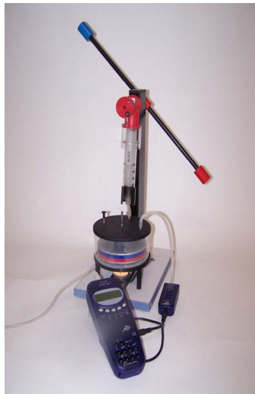
Fig. 1 Montagem da experiência para aceitação dos valores de pressão de funcionamento do motor Stirling segundo Wilke em rotação
