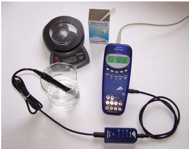
Fig. 1 Erhöhung der Leitfähigkeit von destilliertem Wasser durch Kochsalz-Zugabe
