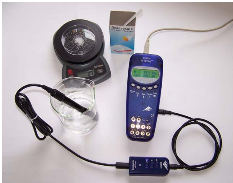
Fig. 1 Aumento de la conductividad del agua destilada por adición de sal de cocina
