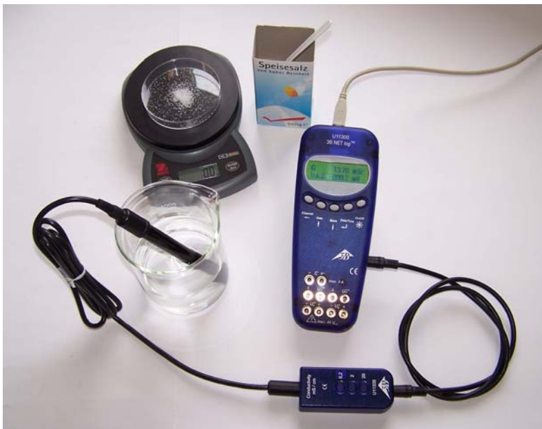
Fig. 1 Augmentation de la conductivité de l'eau distillée par l'addition de sel de cuisine
