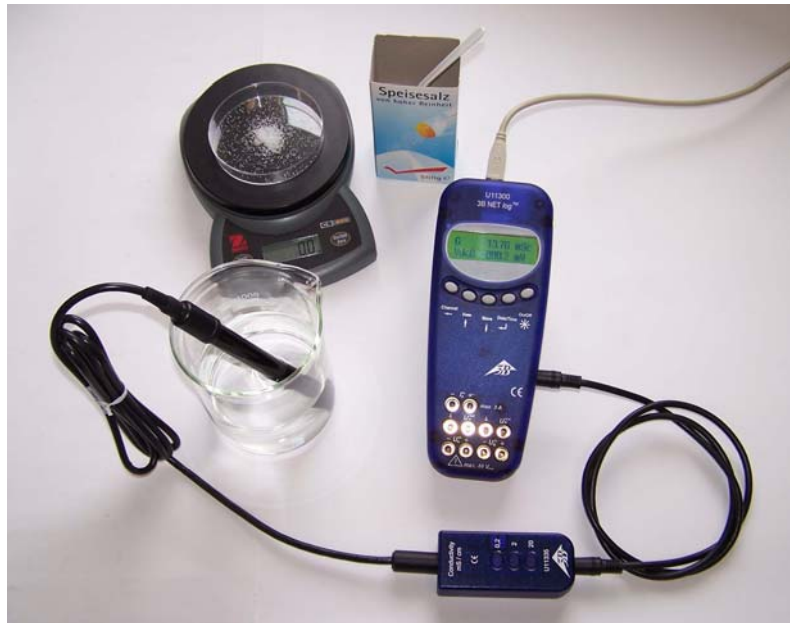
Fig. 1 Aumento della conduttività dell'acqua distillata mediante aggiunta di sale da cucina
