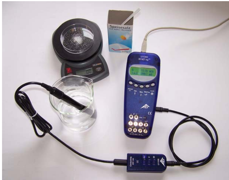
Fig. 1 Aumento da condutibilidade da água destilada por adição de sal de cozinha
