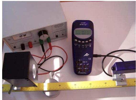
Fig. 1 Messung des Quadratischen Abstandsgesetzes für eine punktförmige Lichtquelle
