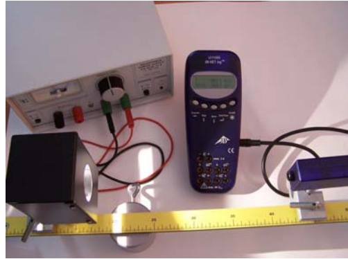
Fig. 1 Mesure de la loi en carré inverse pour une source lumineuse ponctuelle
