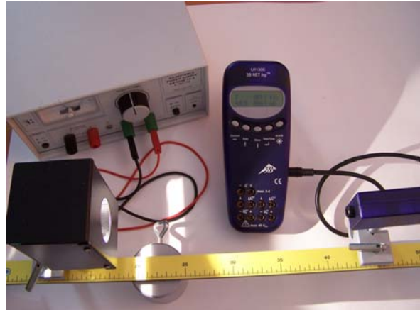
Fig. 1 Medición de la ley del cuadrado de la distancia para una fuente de luz puntiforme
