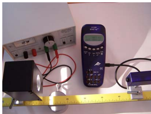
Fig. 1 Medição da lei quadrática (ao quadrado) da lei de distanciamento para uma fonte puntiforme
