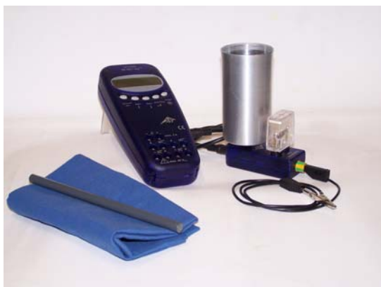
Fig. 1 Struttura sperimentale per la misurazione di cariche nell'ambito dell'elettrostatica
