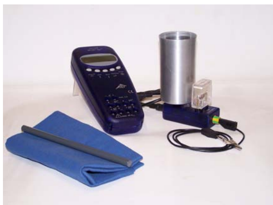
Fig. 1 Montagem de experiência para a medição das cargas na eletrostática
