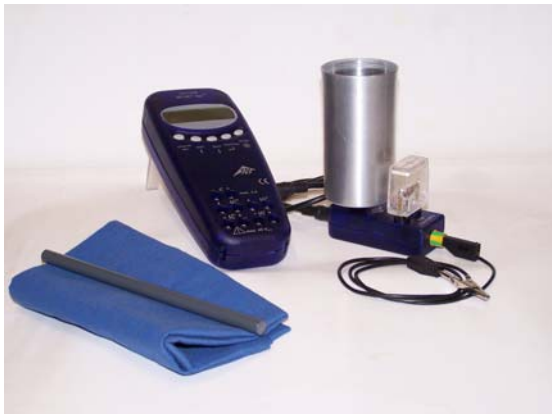
Fig. 1: Versuchsaufbau zur Messung von Ladungen in der Elektrostatik
