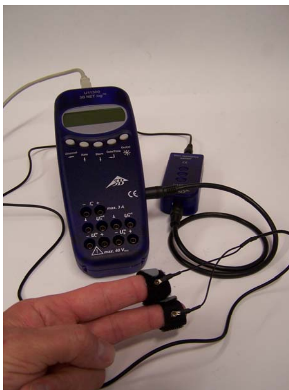
Fig. 1 Medição da resistência da pele de uma pessoa-teste
