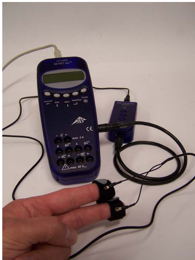
Fig. 1 Messung des Hautwiderstandes einer Testperson
