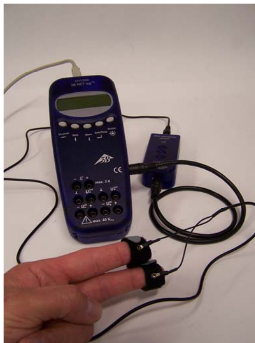
Fig. 1 Medición de la resistencia de la piel de una persona de prueba
