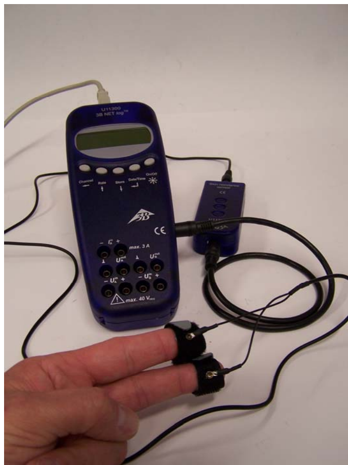
Fig. 1 Mesure de la résistance cutanée d'une personne
