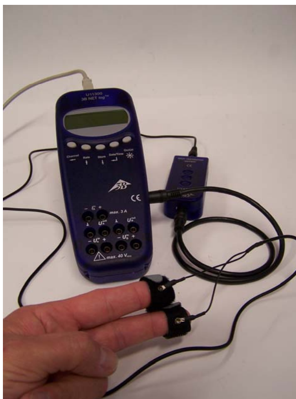
Fig. 1 Misurazione della resistenza cutanea di una persona
