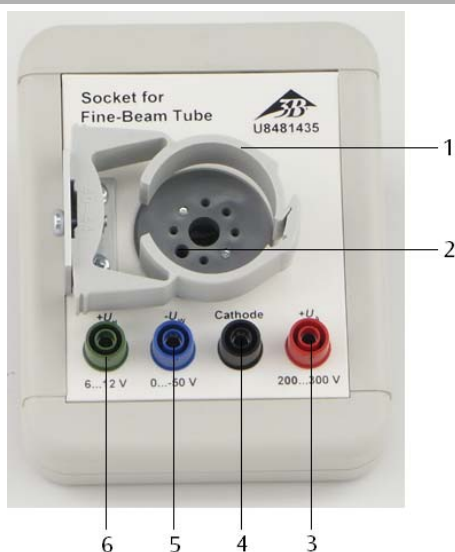
Fig. 1 Sockel: 1 Halteklammer, 2 Öffnung für Führungsstift, 3 Anschluss für Anode, 4 Anschluss für Katode, 5 Anschluss für Wehnelt-Zylinder, 6 Anschluss für Heizung
