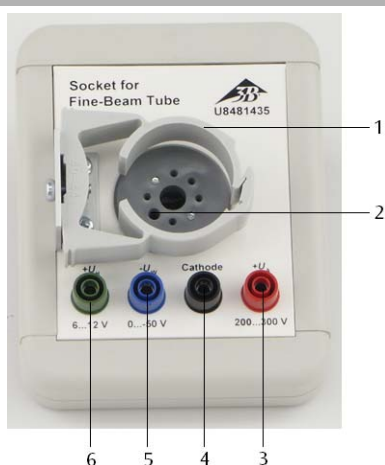
Fig. 1 Zócalo: 1 brida soporte, 2 apertura para la espiga guía, 3 contacto para ánodo, 4 contacto para cátodo, 5 contacto para cilindro de Wehnelt, 6 contacto para caldeo
