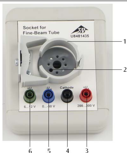
Fig. 1 zoccolo: 1 morsetto di supporto, 2 apertura per spinotto di guida, 3 jack di raccordo per anodo, 4 jack di raccordo per catodo, 5 jack di raccordo per cilindro di Wehnelt, 6 jack di raccordo per spirale riscaldante
