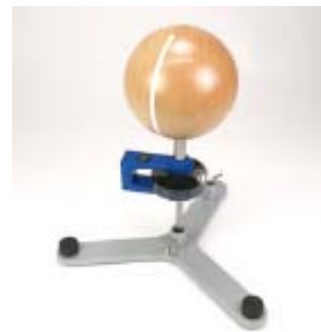
Fig. 6 Determinazione del momento d'inerzia di una sfera
