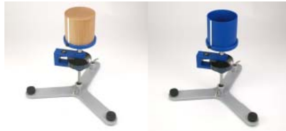
Fig. 5 Comparaison des moments d'inertie de cylindres
