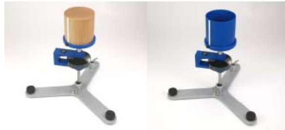
Fig. 5 Comparação dos momentos de inércia de cilindros
