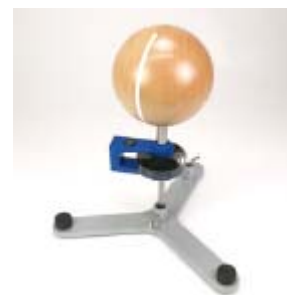
Fig. 6 Déterminer le moment d'inertie d'une sphère
