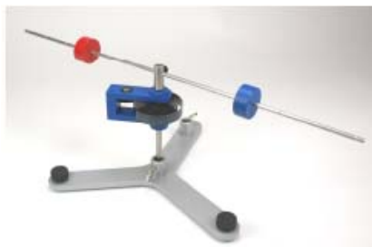
Fig. 3 Dependencia del momento de inercia J de la distancia r
