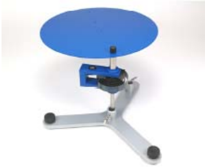
Fig. 7 Confirmación del teorema de Steiner
