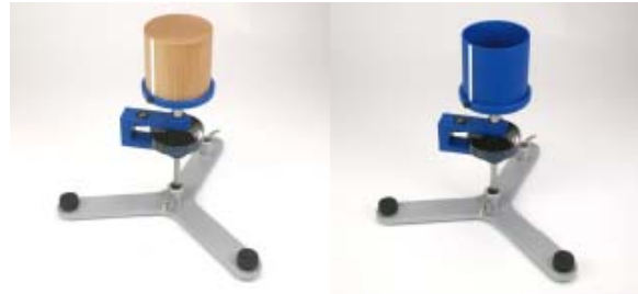
Fig. 5 Confronto dei momenti d'inerzia di cilindri
