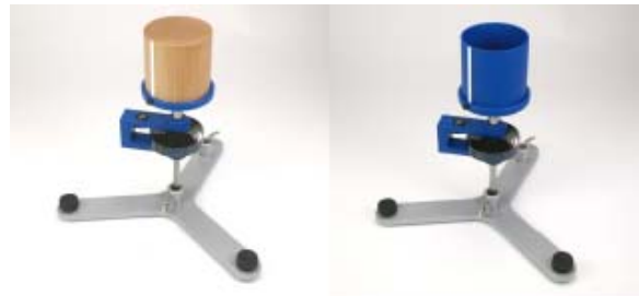
Fig. 5 Vergleich der Trägheitsmomente von Zylindern
