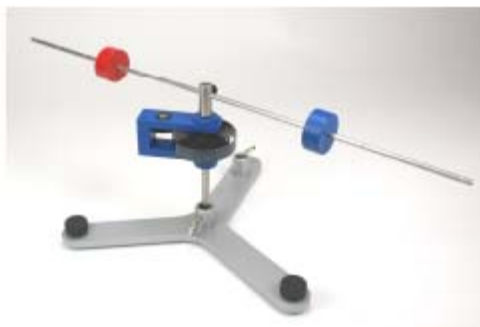
Fig. 3 Rapport entre le moment d'inertie J et l'écart r
