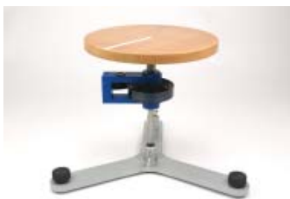
Fig. 4 Determinazione del momento d'inerzia di un disco
