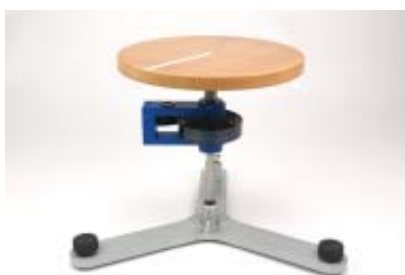
Fig. 4 Determinación del momento de inercia de un disco de madera
