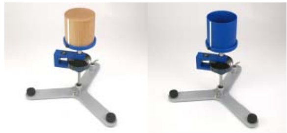
Fig. 5 Comparación del momentos de inercia de cilindros
