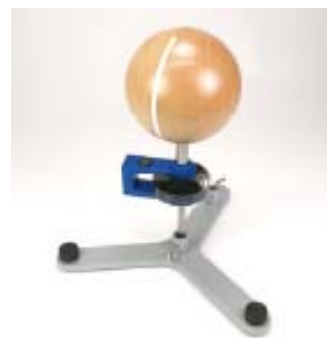
Fig. 6 Determinação do momento de inércia de uma esfera
