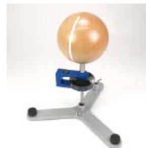
Fig. 6 Bestimmung des Trägheitsmomentes einer Kugel
