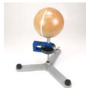
Fig. 6 Determinación del momento de inercia de una esfera
