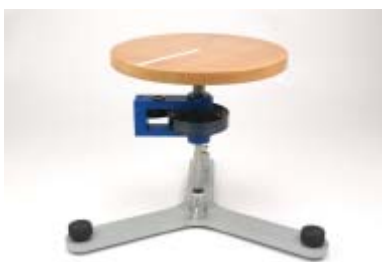
Fig. 4 Déterminer le moment d'inertie d'un disque en bois
