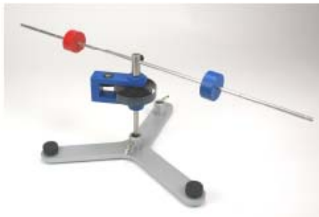
Fig. 3 Dipendenza del momento d'inerzia J dalla distanza r
