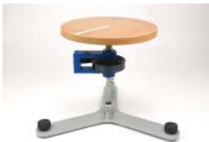
Fig. 4 Bestimmung des Trägheitsmomentes einer Holz-scheibe
