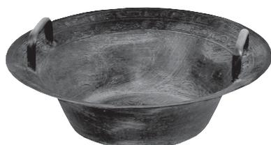
El cuenco de resonancia permite la demostración del fenómeno de las ondas estacionarias en un recipiente de bronce lleno de agua.
