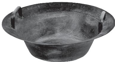
Das Resonanzbecken ermöglicht die Demonstration stehender Wellen in einer mit Wasser gefüllten Bronzeschüssel.
