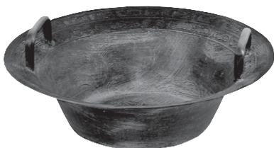
O tanque de ressonância permite a demonstração da formação das ondas estacionárias num recipiente de bronze contendo água.
