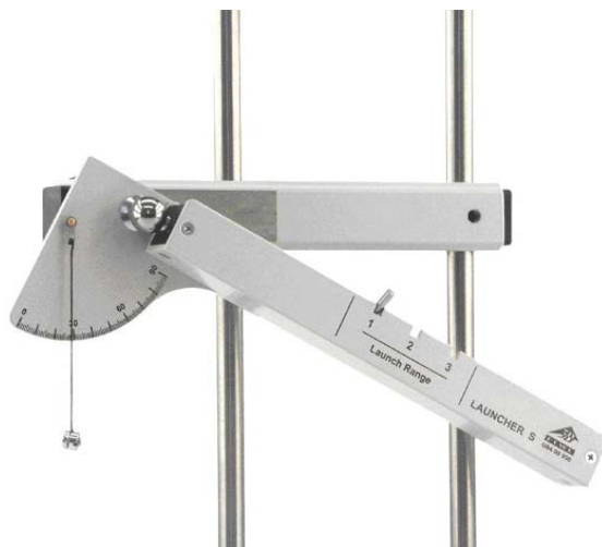
Fig. 2 Struttura sperimentale lancio obliquo
