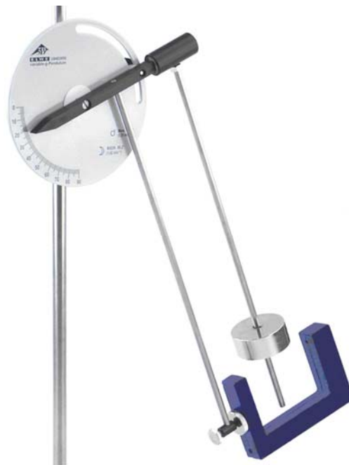
Fig. 1 Pêndulo variável em g com suporte da barreira fotoelétrica
