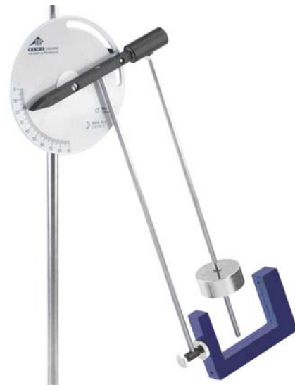
Fig. 1 Péndulo-g-variable con soporte de puerta fotoeléctrica
