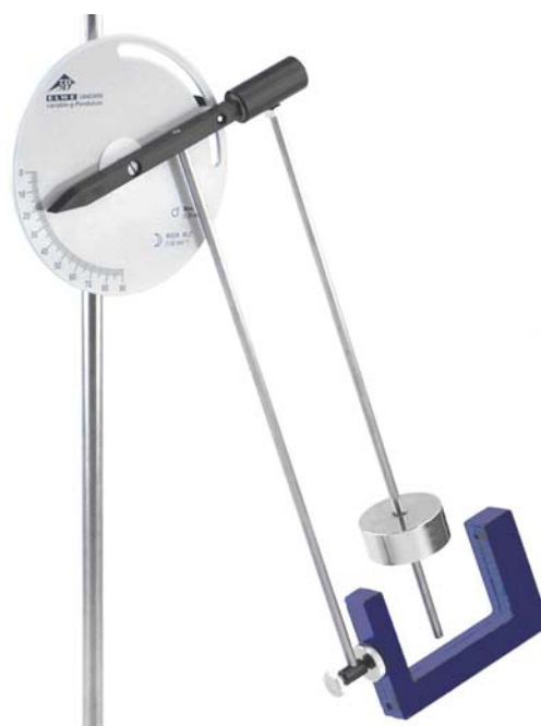
Fig. 1 Pendolo gravitazionale variabile con dispositivo di supporto e fotocellula
