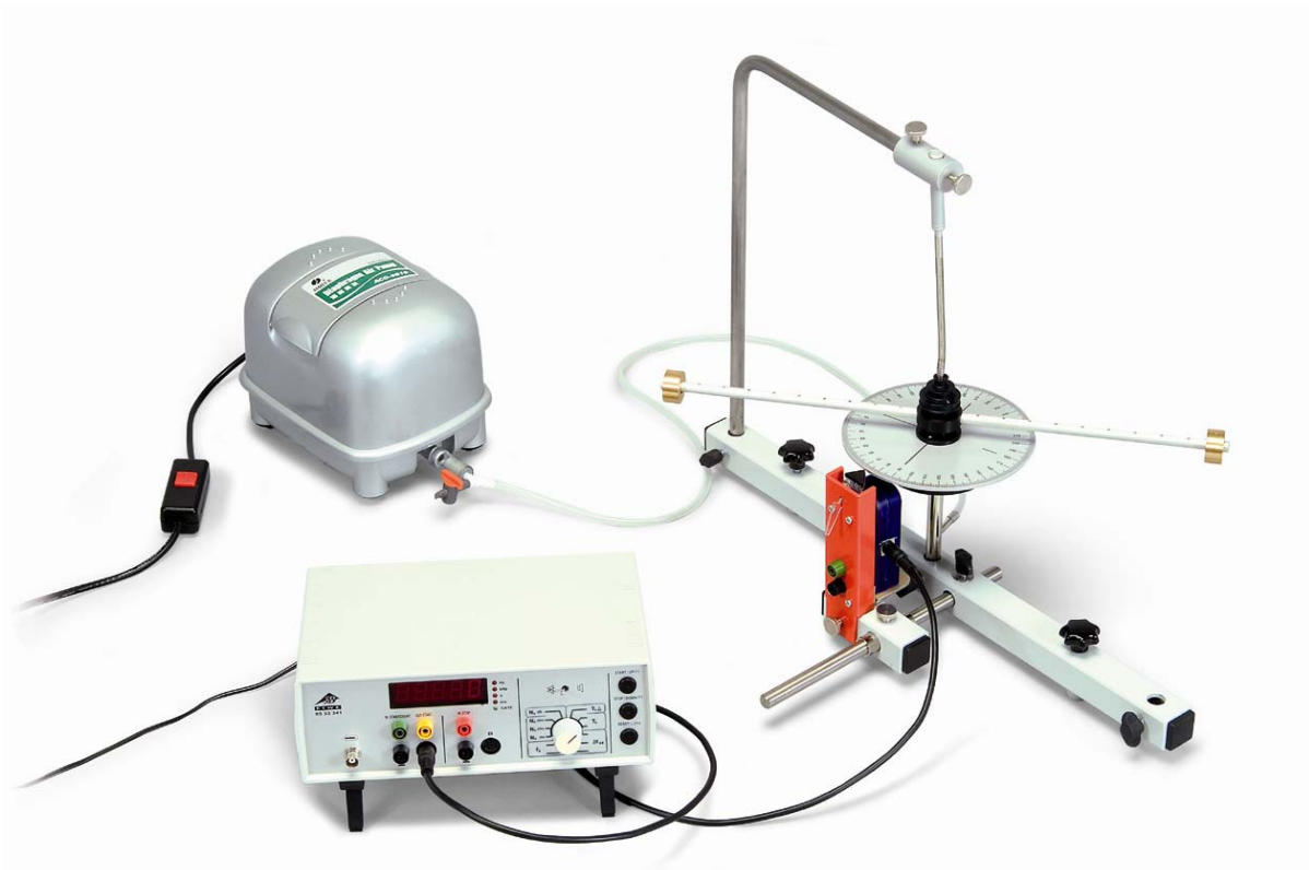
Fig. 2 Experimenteller Aufbau zur Bestimmung des Trägheitsmoments einer Hantelstange mit Zusatzmassen mit dem Laserreflexsensor (U8533380) und dem Digitalzähler (U8533341)
