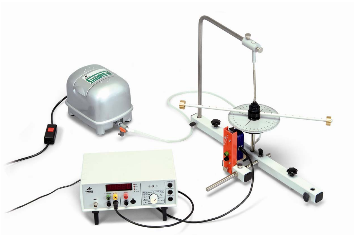
Fig. 2 Montagem experimental para a determinação do momento de inércia de uma barra de pesos com medidas de aditamento com o sensor de reflexão de laser (U8533380) e o contador digital (U8533341)
