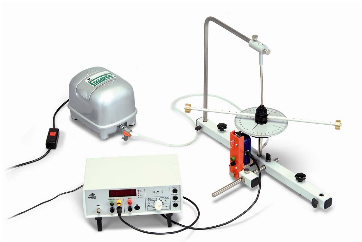
Fig. 2 Struttura sperimentale per la determinazione del momento d'inerzia di un'asta manubrio con masse supplementari con il sensore di riflessione laser (U8533380) e il contatore digitale (U8533341)
