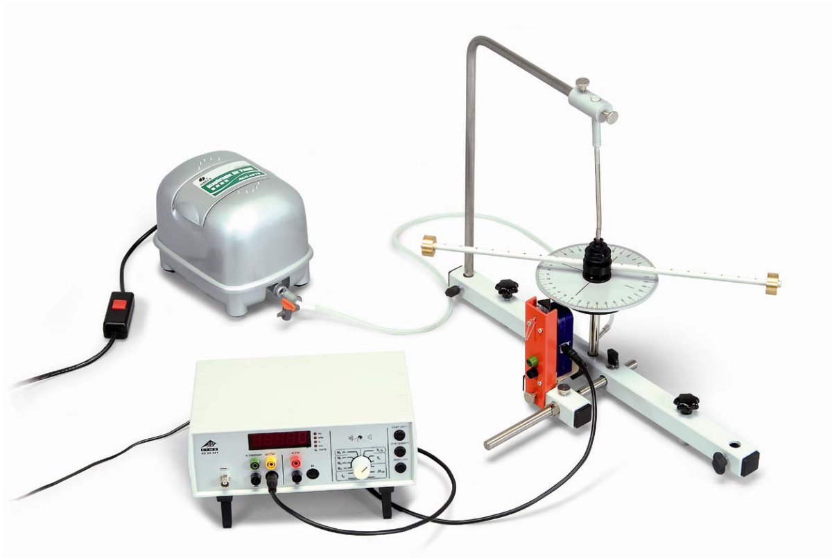
Fig. 2 Montaje experimental para la determinación del momento de inercia de una varilla de haltera con masas adicionales utilizando el sensor de reflexión de Láser (U8533380) y el contador digital (U8533341)
