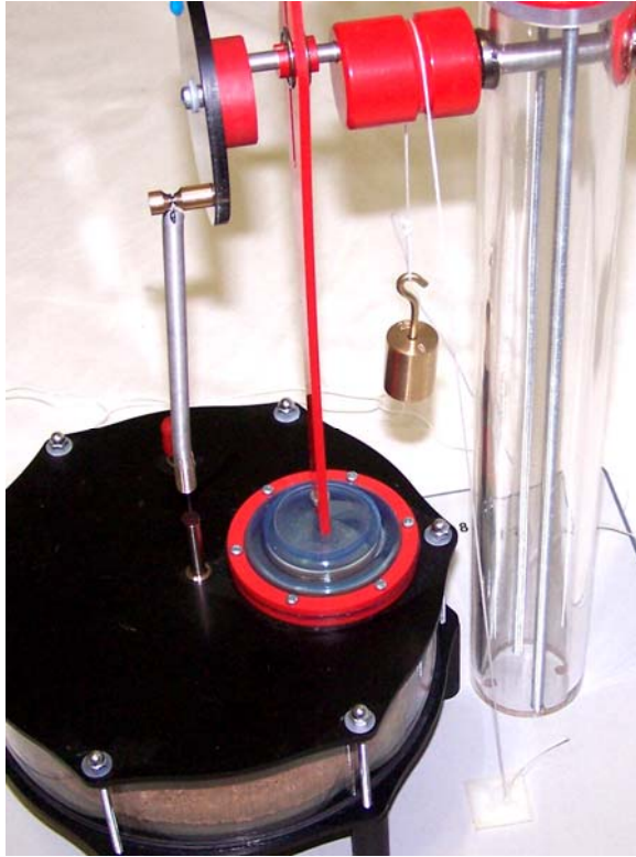
Fig. 6 Fixação do fio com uma peça de massa
