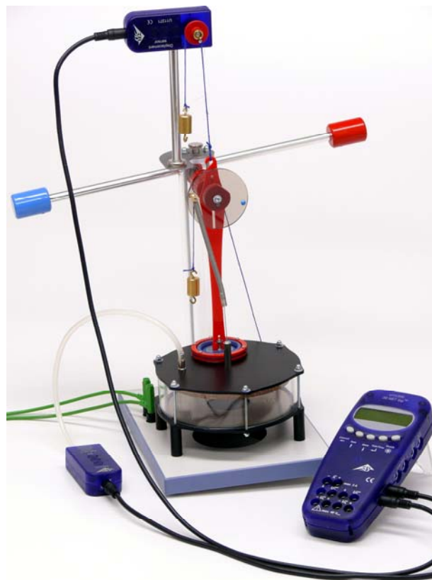
Fig. 8 Aufbau zur Aufzeichnung des Druck-Volumen-Diagramms
