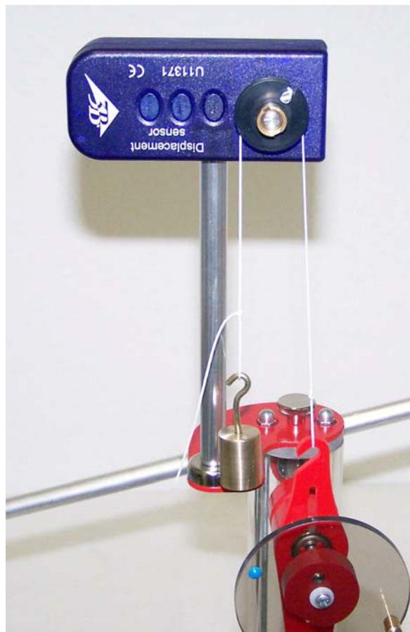
Fig. 5 Befestigung des Fadens am Pleuelhaken
