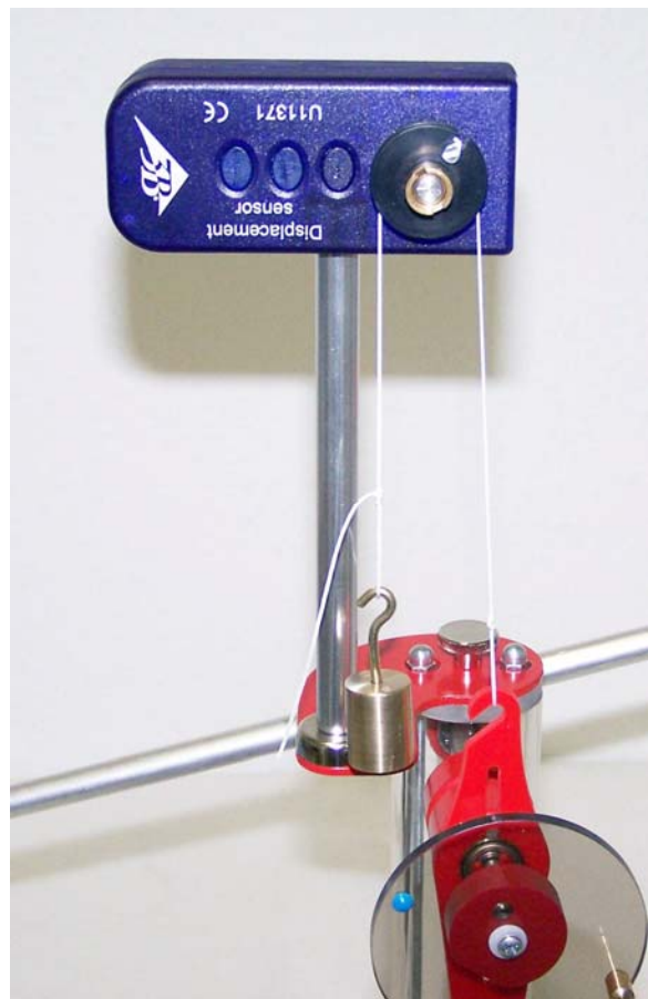
Fig. 5 Fixação do fio no entalho do excêntrico
