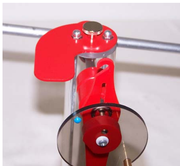
Fig. 1 Montaggio della piastra di supporto
