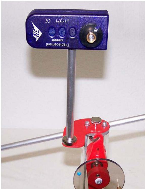
Fig. 2 Montaje del captador de camino
