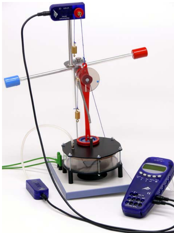
Fig. 8 Montaje para el registro del diagrama Presión-Volumen
