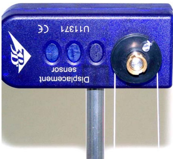
Fig. 3 Guidage du fil autour de la poulie
