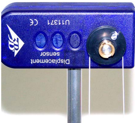
Fig. 3 Condução do fio em volta do rolo
