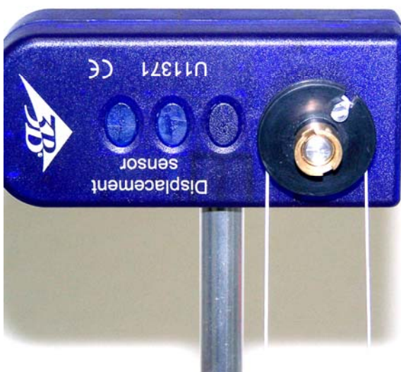
Fig. 3 Guía del hilo alrededor de la roldana
