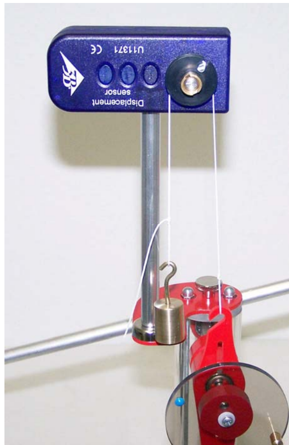
Fig. 5 Fixation du fil au crochet de la bielle
