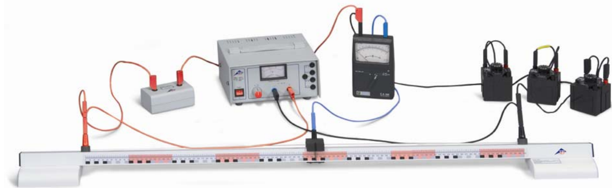
Fig. 2 Determinación de una resistencia en un circuito puente de Wheatston
