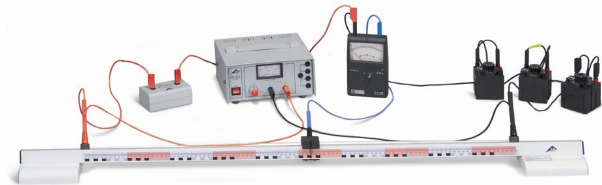
Fig. 2 Determinazione di una resistenza in un collegamento a ponte di Wheatstone
