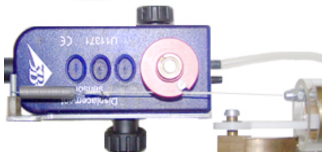
Fig. 2 Montage des Fadens auf der Schnurrolle des Wegaufnehmers
