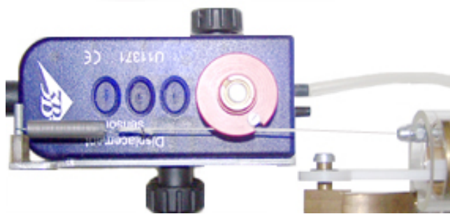
Fig. 2 Montaje del hilo en la roldana de cuerda del captador de camino
