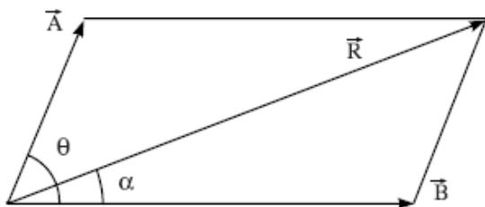
Cet énoncé peut être exprimé mathématiquement de la manière suivante. Si l'écart entre deux forces  $\vec{A}$  et  $\vec{B}$  agissant sur un corps représente l'angle  $\theta$ , la résultante  $\vec{R}$  est déterminée par
