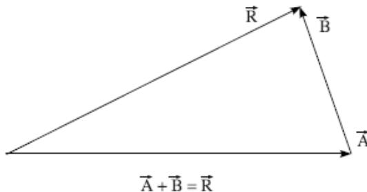
Disto resulta que um corpo se encontra em equilíbrio quando três forças agem sobre ele, que são representadas pelos três lados de um triângulo.
