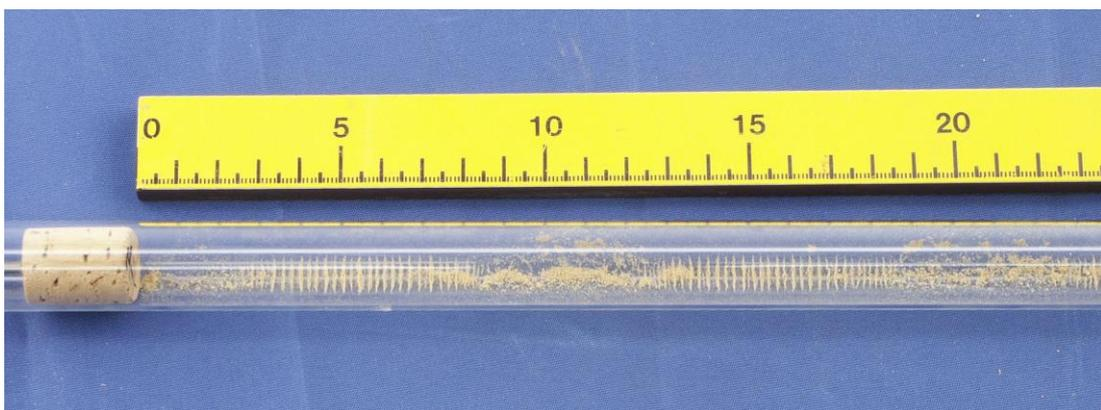
Fig. 1 Determinación de la longitud de onda
