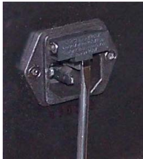
Fig.1 Troca de fusíveis
