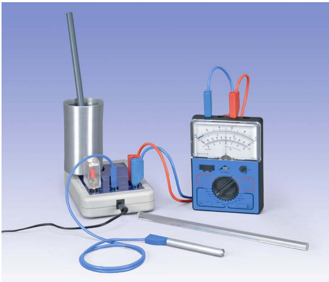
Fig. 1 Montaje experimental para la medición de la carga en la electrostática
