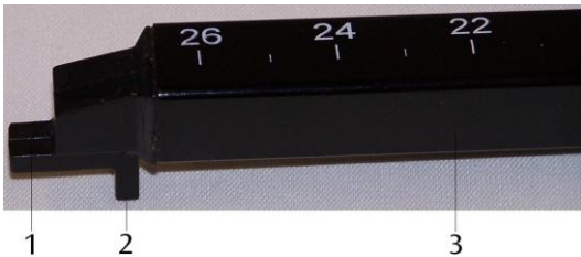
Sonda de campo magnético: 1 Sonda de Hall tangencial (Dirección z), 2 Sonda de Hall axial (Dirección x), 3 Soporte
