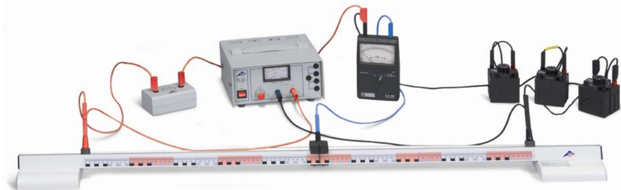
Fig. 2 Bestimmung eines Widerstands in einer Wheatstone'schen Brückenschaltung
