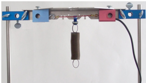
Fig. 3 Montaggio della traversa nello stativo
