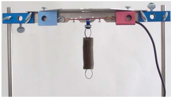
Fig. 3 Montage der Traverse im Stativ
