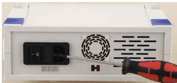
Fig. 1 Sostituzione dei fusibili
