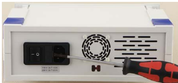
Fig. 1 Troca de fusíveis
