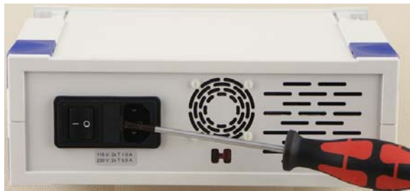
Fig. 1 Reemplazo de fusibles
