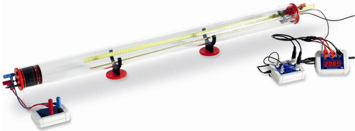
Fig. 2: Montaje experimental con el tubo de Kundt
