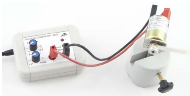
Fig. 1 Montagem do experimento para demonstração da alteração do sentido do giro de um motor de corrente contínua
