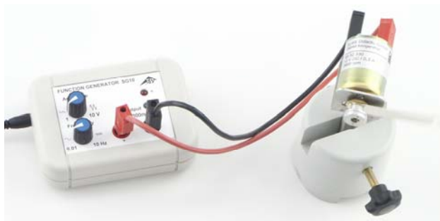
Fig. 1 Struttura sperimentale per la dimostrazione della modifica del senso di rotazione di un motore a corrente continua
