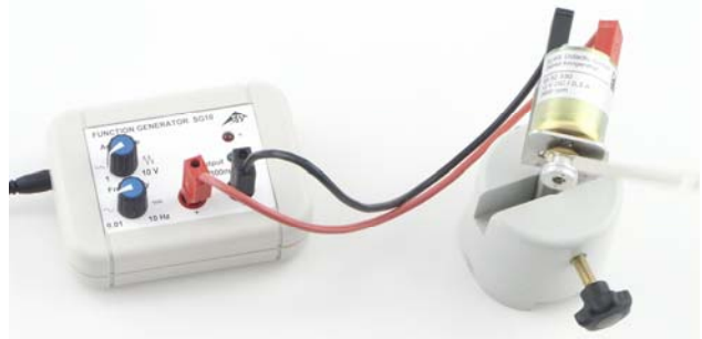
Fig. 1 Experimentieraufbau zur Demonstration der Drehrichtungsänderung eines Gleichstrommotors
