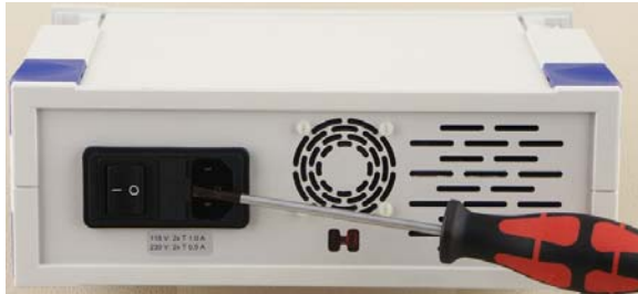
Fig. 1 Sostituzione dei fusibili
