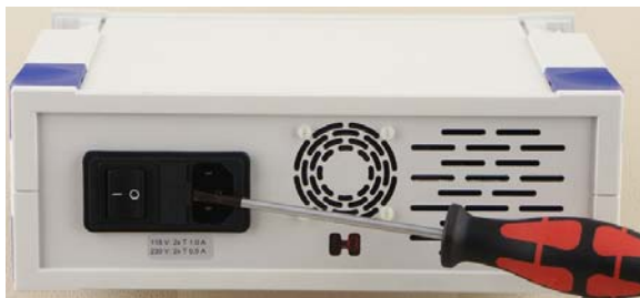
Fig. 1 Remplacement de fusible
