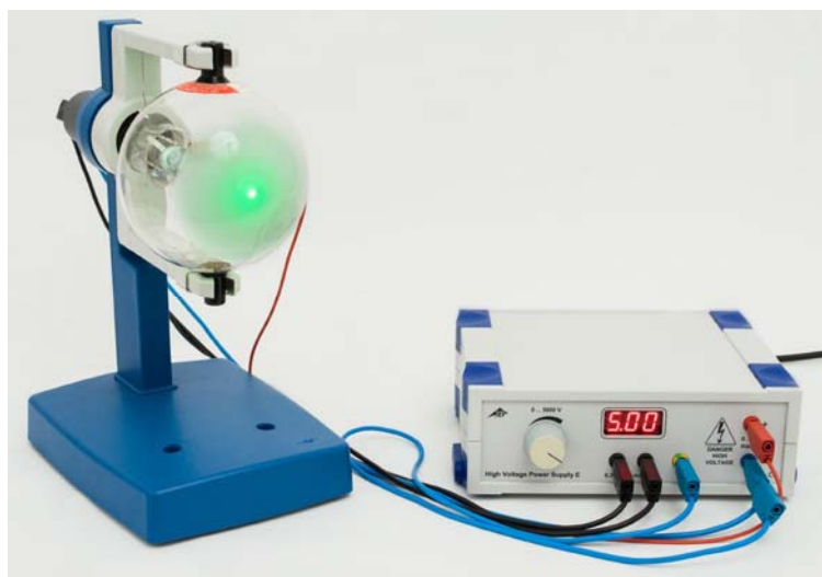
Fig. 2 Funcionamiento del tubo de difracción de electrones
