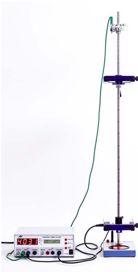
Fig. 2: Montaje experimental para la medición de la velocidad media.
