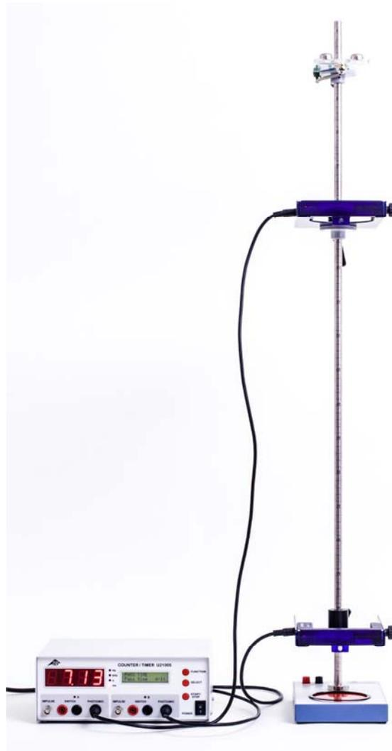
Fig. 1: Montaje experimental para la medición de la velocidad instantánea.
