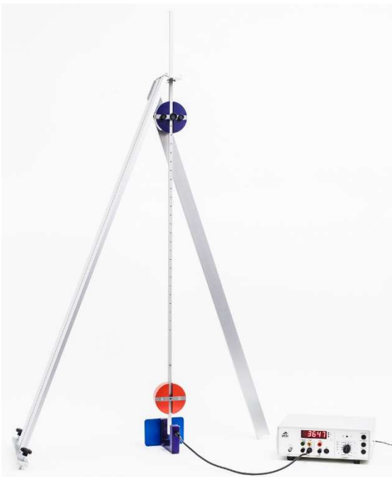
Fig. 5: Montaje experimental con puerta fotolétrica y contador digital
