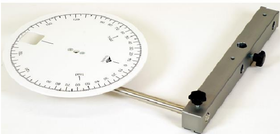
Fig. 2: Montaje del disco graduado y del travesaño inferior en la varilla transversal.
