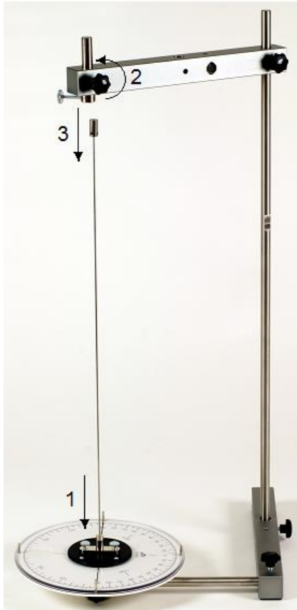
Fig. 5: Atornillado de la varilla redonda en el disco pendular, por medio del estribo de fijación y engastado del casquillo tensor en el cilindro del casquillo tensor.
