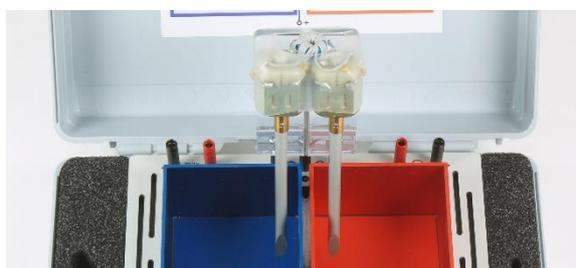
Fig. 2: Unidad de agitación con los agitadores
