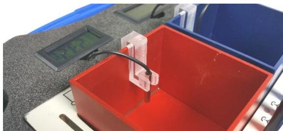
Fig. 1: Colocación del sensor de temperatura
