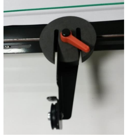
Polea de compensación colocada en uno de los soportes de la mesa suministrados (vista desde arriba)
