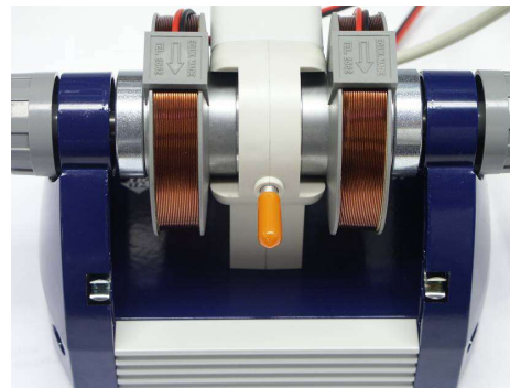
Fig. 2 Unidad base con la muestra de DPPH insertada
