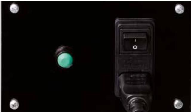
Abb. 3: Hauptschalter an der Rückseite des Simulators
