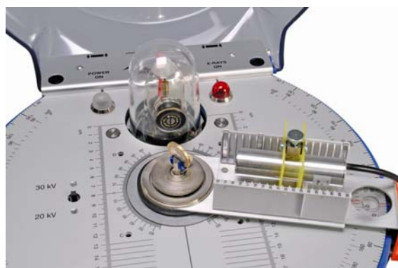
Fig. 2 Montaggio del rivelatore di raggi X nel braccio del goniometro dell'apparecchio per raggi X (U192001)
