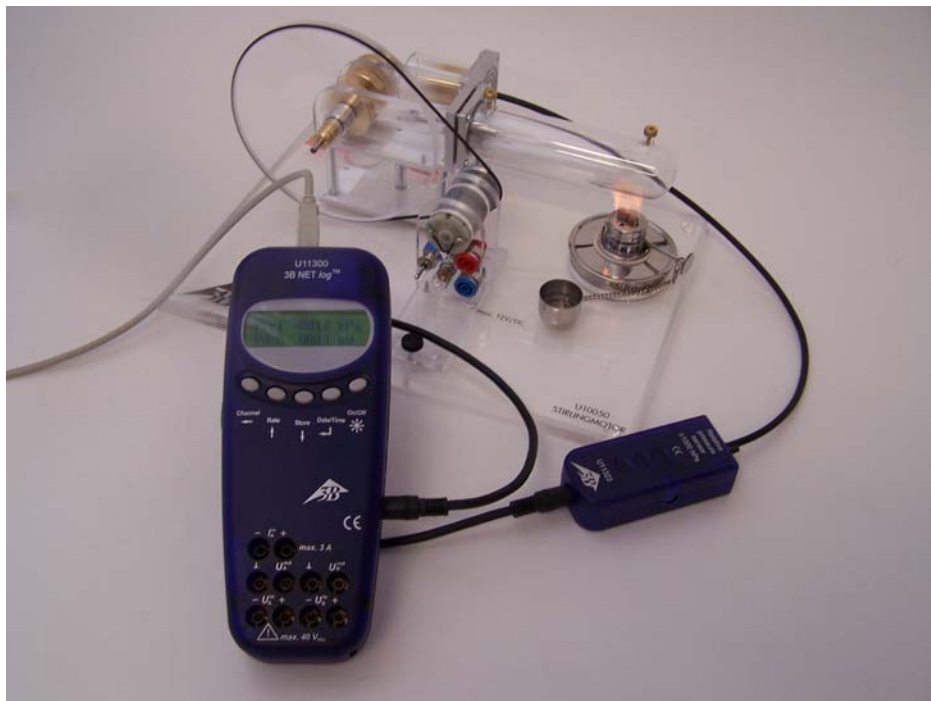
Fig. 1 Montagem da experiência para aceitação dos valores de pressão de funcionamento do motor Stirling U10050 em rotação
