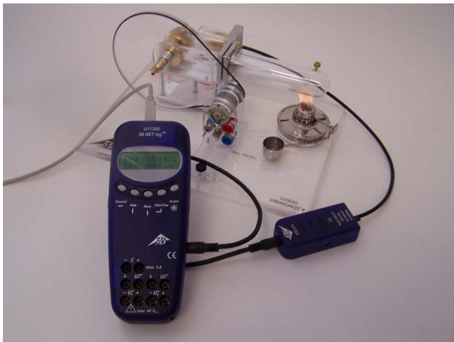
Fig. 1 Montage de l'expérience destiné à l'enregistrement des valeurs de pression de service dans le moteur Stirling U10050 en rotation
