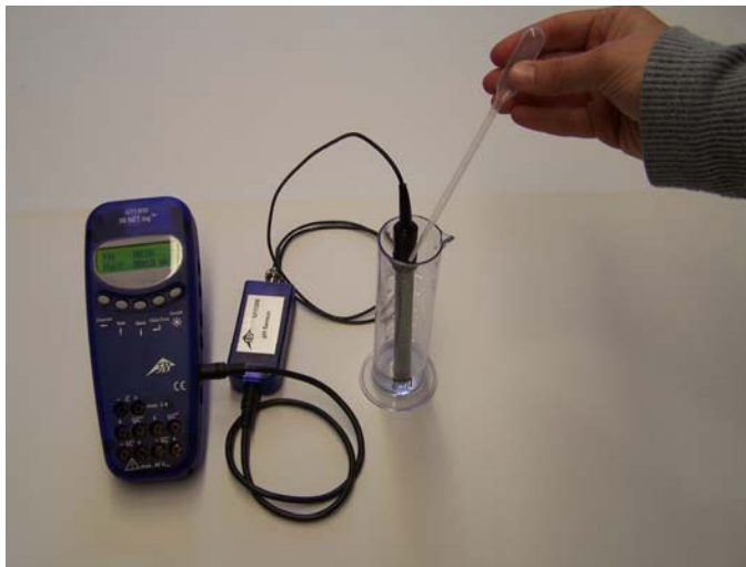
Fig. 1: Determinación cuantitativa de la curva de titración de vinagre
