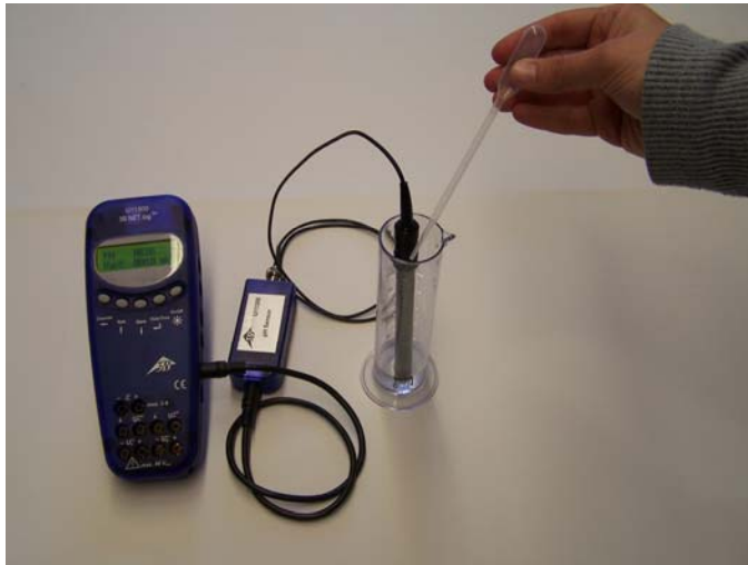
Fig. 1: Qualitative Ermittlung der Titrationskurve von Essig
