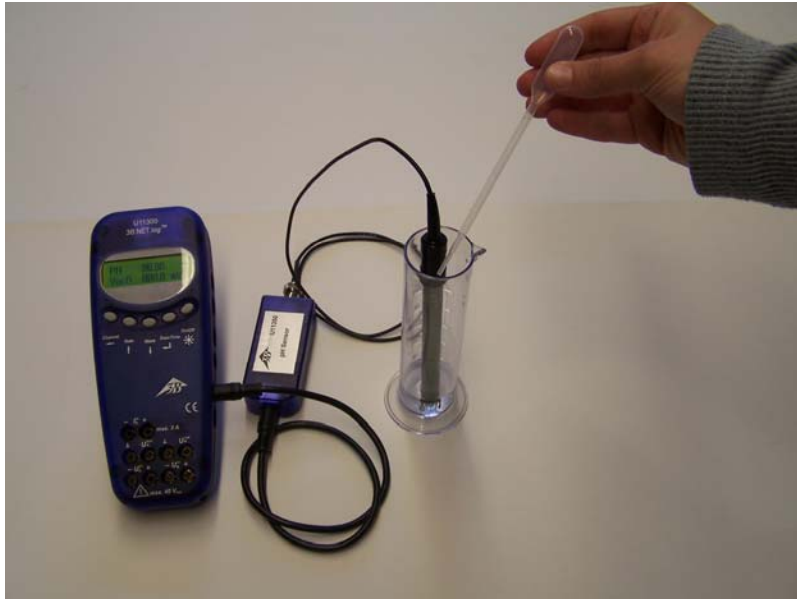
Fig. 1: rilevamento qualitativo della curva di titolazione dell'aceto
