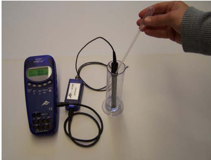
Fig. 1 : Détermination qualitative de la courbe de titration du vinaigre
