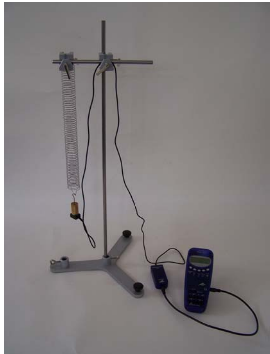
Fig. 1 Mesure de l'accélération dans un système amorti-oscillant de ressorts et de poids
