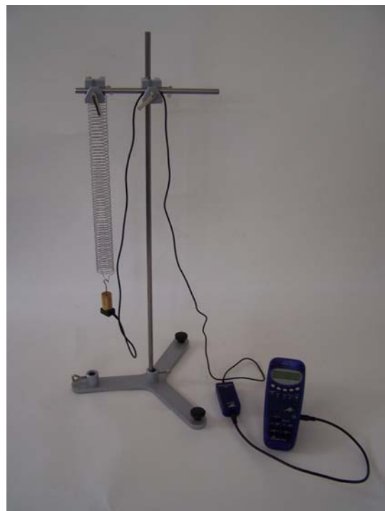
Fig. 1 Messung der Beschleunigung in einem gedämpft-schwingenden Feder-Masse-System
