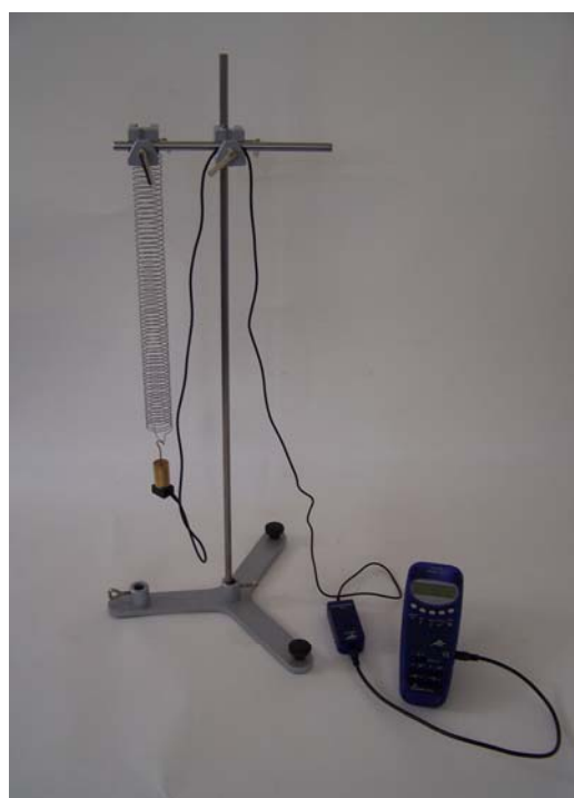
Fig. 1 Misurazione dell'accelerazione di un sistema molla-peso a oscillazione attenuate
