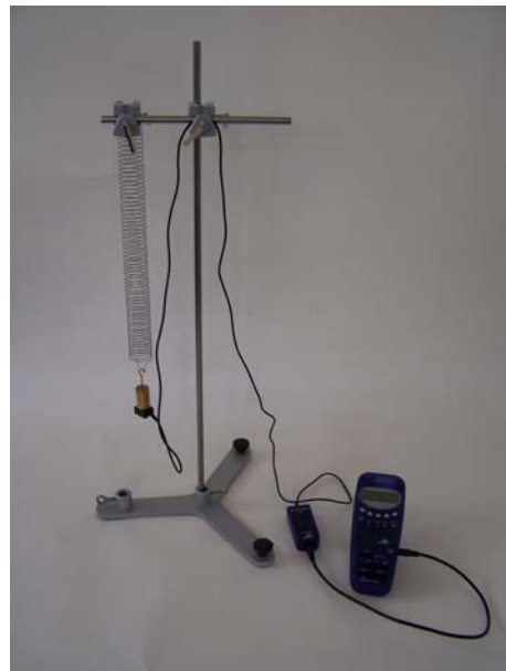
Fig. 1 Medición de la aceleración de un sistema Masa – Muelle de oscilación amortiguada
