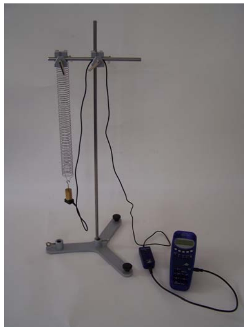
Fig. 1 Medição da aceleração de um sistema mola-massa de oscilação amortecida
